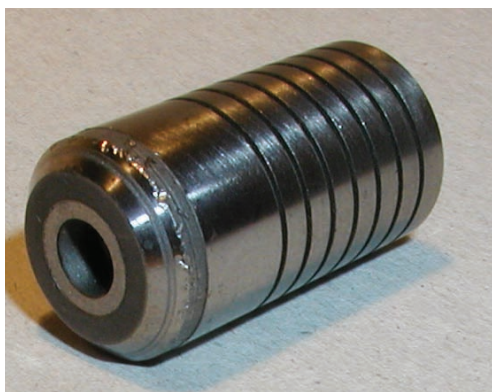
Fot. 1. Uszkodzone krąwędzie elementu w konsekwencji „efektu papieru ściernego”
