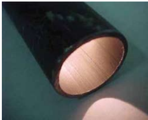
Fot. 4. Czyste wnętrze przewodu wskutek zastosowania ELC
