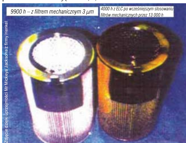
Fot. 10. Porównanie wyglądu siatkowych filtrów podciśnieniowych z filtrem mechanicznym 3 µm oraz filtrów z ELC
