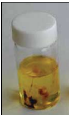
Fot. 7. Produkty utleniania oleju nierozpuszczalne w bazie olejowej
