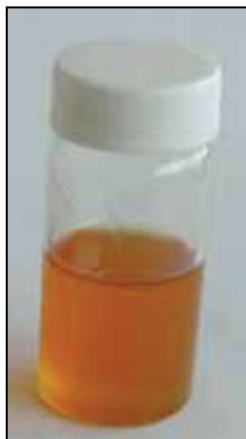
Fot. 8. Mętna mieszanina rozpuszczonych produktów utleniania oleju przy zastosowaniu płuczki ultradźwiękowej
