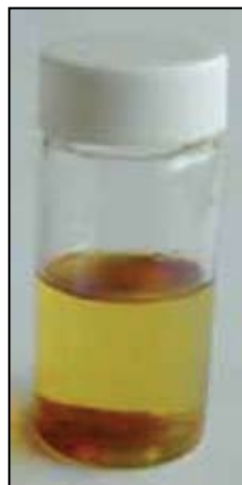
Fot. 9. Ta sama co na zdjęciu 8 mieszanina rozpuszczonych produktów utleniania oleju po 1 tygodniu stania
